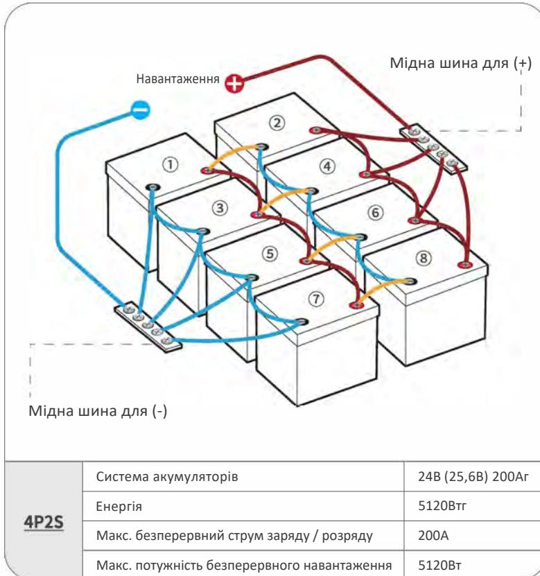
1) Оскільки (+) (1) / (3) / (5) / (7) з'єднано послідовно з (-) (2) / (4) / (6) / (8), будь ласка, не підключайте (+) (1) / (3) / (5) / (7) до (+) навантаження або (-) (2) / (4) / (6) / (8) до (-) навантаження, інакше система батареї не зможе з'єднатися послідовно.
