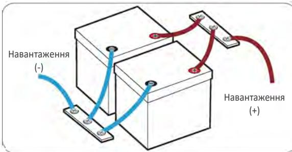
Після паралельного підключення ємність акумуляторної системи буде подвоєна відповідно до кількості підключених батарей.
