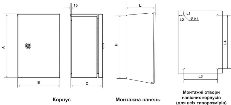
\* допустиме відхилення габаритних розмірів  $\pm 2,5$  мм
