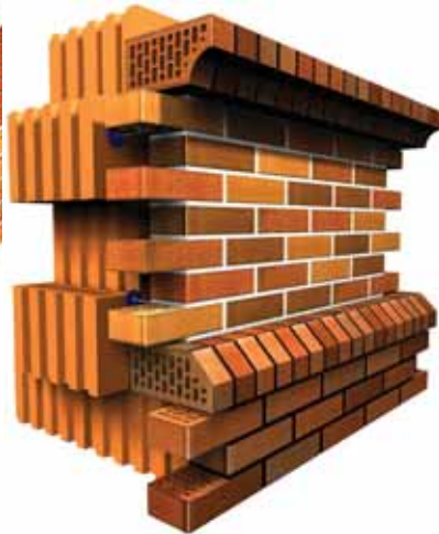
Карниз и пилястр на примере фасонного кирпича Ф3 и Ф2
