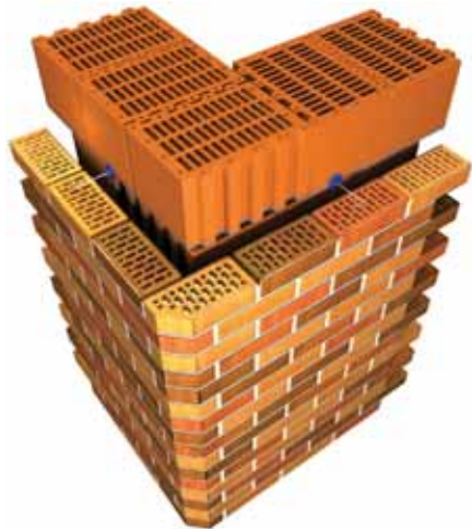
Угол дома 90° на примере фасонного кирпича Ф2
