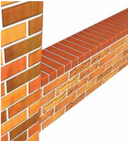
Накровка на пролеты заборов на примере фасонного кирпича Пр 1/2
