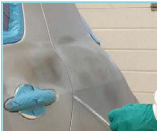
3) После нанесения грунта и цикла сушки ленту для перехода необходимо удалить, потянув за закрепленный край. Загрунтованную область зашлифовать согласно технологии, обезжирить и подготовить к окраске финишными покрытиями.
