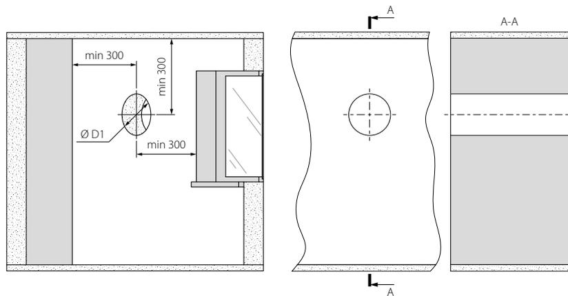
2. Встановіть повітропровід в отвір так, щоб його зрізи збігалися із зовнішньою та внутрішньою поверхнею стіни. Для зручності монтажу використовуйте пінопластові клини, які входять до комплекту постачання.
