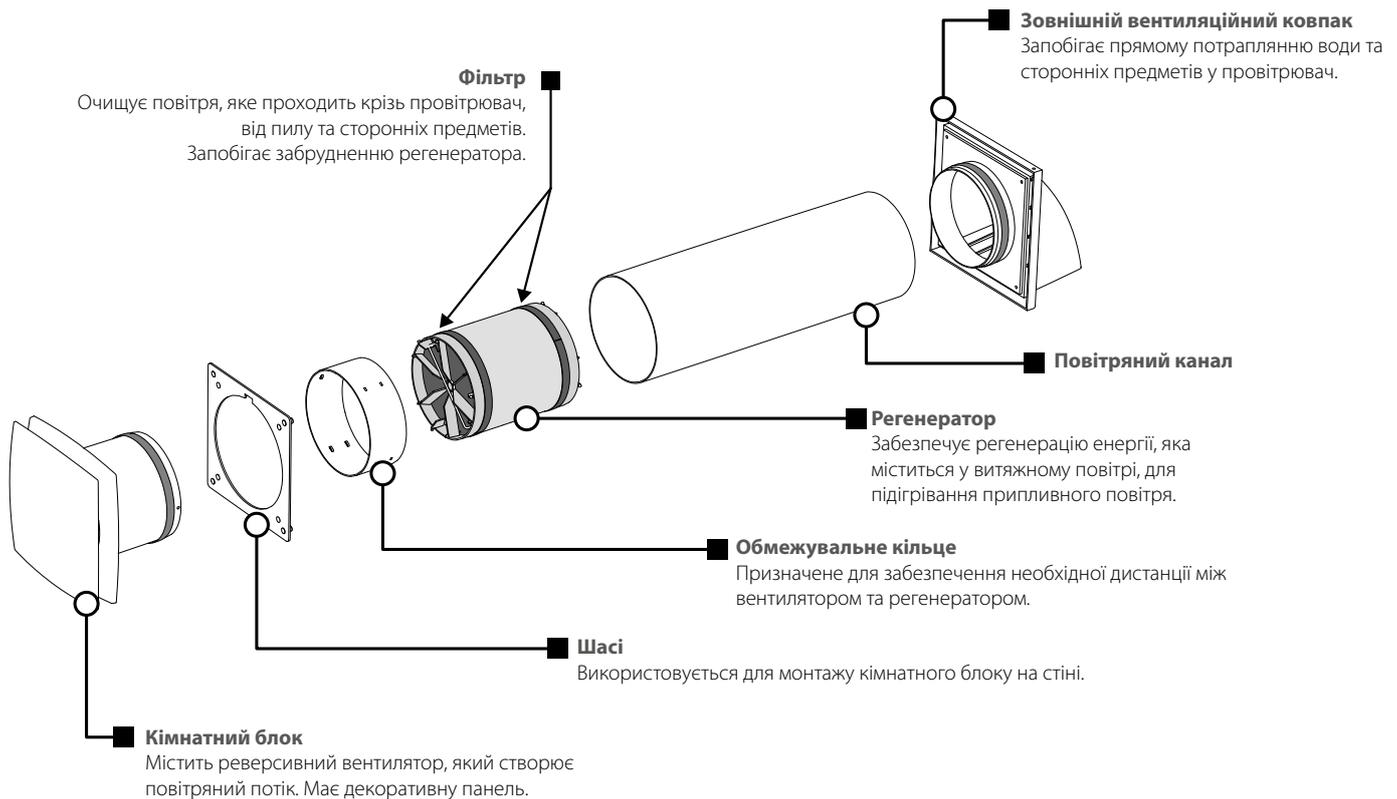
Провітрювач працює у два цикли по 60 секунд.
