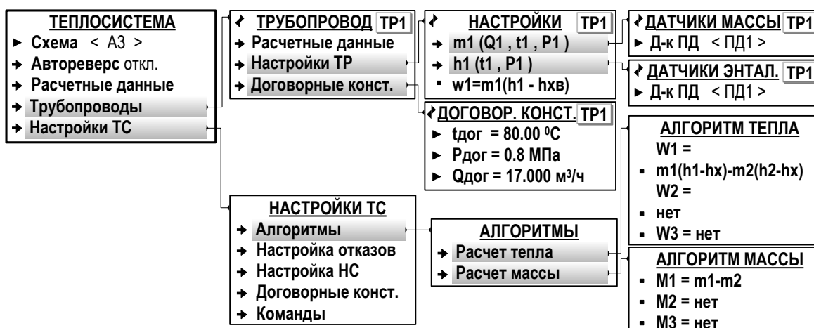
Рис.19. Вид меню настройки алгоритмов расчеты тепла и массы в трубопроводах и теплосистеме (режим СЕРВИС).
