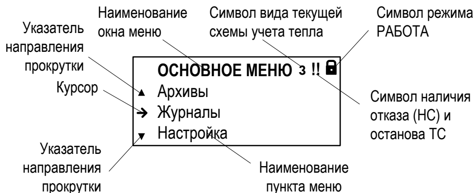
Рис.4. Вид окна индикации тепловычислителя.
