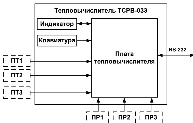
Рис. 1. Структурная схема тепловычислителя исполнения ТСРВ-033.
