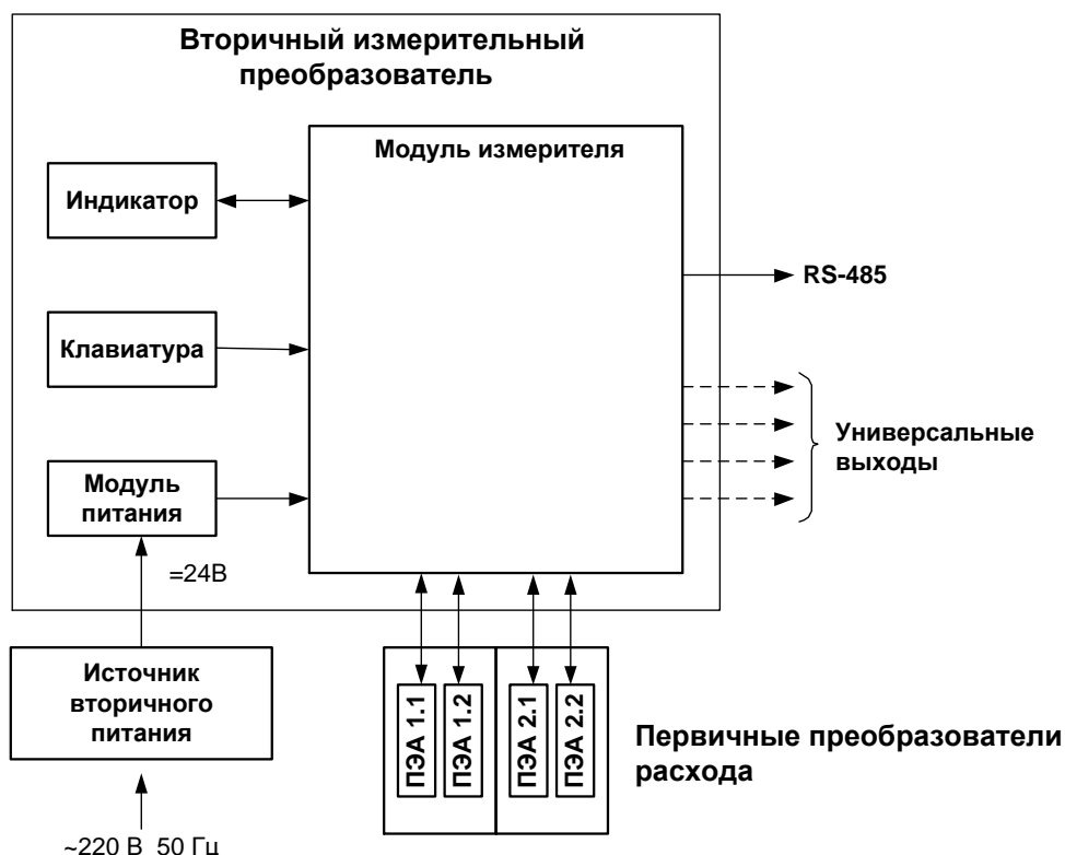
Рис. 4. Структурная схема двухканального расходомера.
