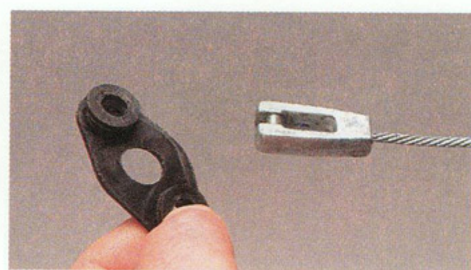
Снимаем прокладку с кронштейна и наконечника троса. Перед установкой деталей наносим на наконечник троса и на втулку педали пластичную смазку.
