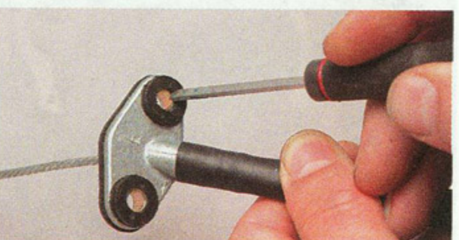
Выталкиваем из отверстий в прокладке кронштейна металлические распорные втулки.
