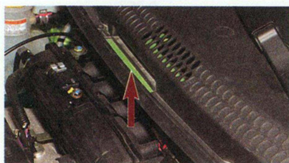
Идентификационный номер автомобиля (VIN) нанесен на нижнюю часть рамки ветрового окна (в середине)
