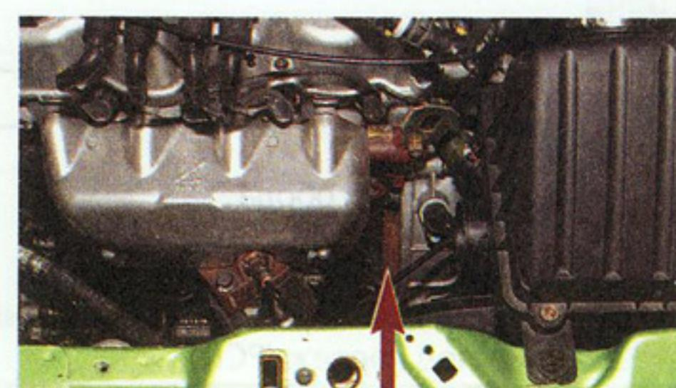
Номер двигателя выбит на площадке блока цилиндров вблизи фланца крепления картера сцепления (место показано стрелкой, резонатор снят)
