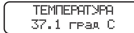
Температура основных элементов прибора, в градусах Цельсия ( $^{\circ}\text{C}$ ). Максимальная температура может составлять не более 80 градусов, в противном случае устройство отключится.
