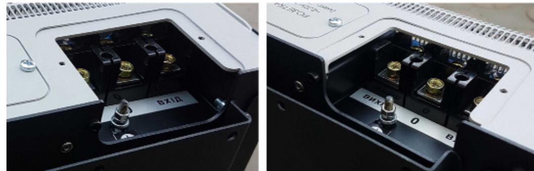
5. Зачистіть та обладнайте наконечником провід захисного заземлення і закріпіть його гайкою на гвинті поруч із клемником у відсіку клемника.
