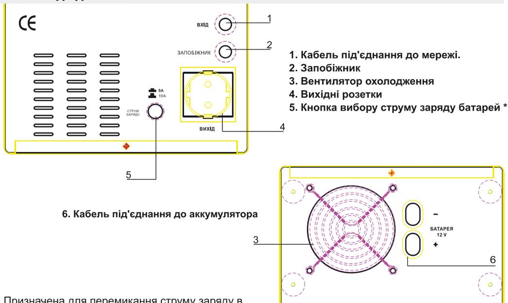
\* Призначена для перемикання струму заряду в залежності від місткості використовуваного акумулятора. Перед використанням ДБЖ, для уникнення виходу акумулятора з ладу (не гарантійний випадок), виберіть струм який відповідає місткості акумулятора, що під'єднуванується згідно з рекомендаціями в таблиці:
