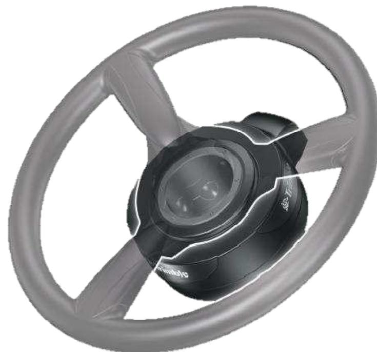
**EZ-Pilot – система вспомогательного управления, которая обеспечивает высокоточное вождение за приемлемую цену. Компактный электрический мотор вращает рулевое колесо удерживая транспортное средство на линии движения.**
