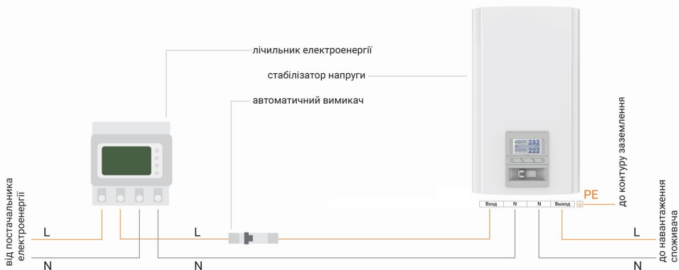
Рисунок 6. Схема підключення стабілізатора КилоГерц до однофазної мережі
