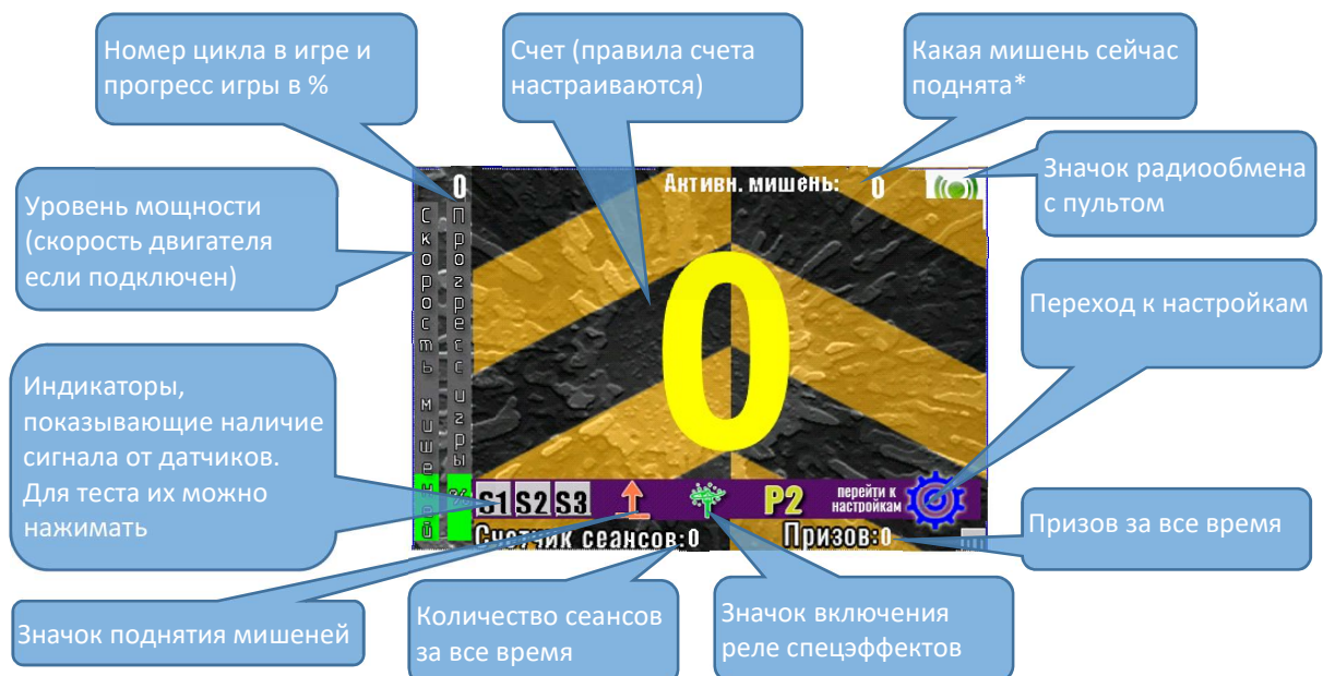
Рис. 1.1 главный экран блока управления мишенями
