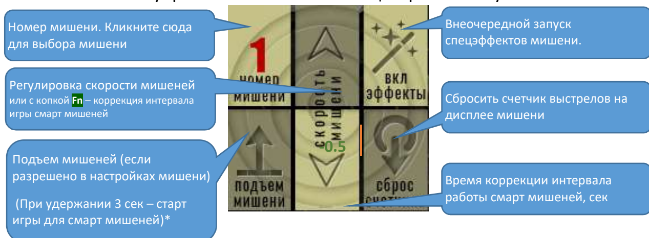
Рис. 1.2 Панель управления мишенями на центральном пульте
