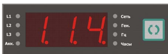
Рис. 5.6. Пример: параметр №114, доступный для редактирования значения.
