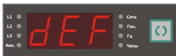
Рис. 5.8. Индикация установки параметров по умолчанию.
