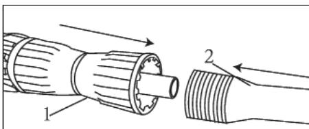
З'єднайте розпилювач і важіль подачі (2). Поверніть стопорну гайку (1), щоб зафіксувати її
