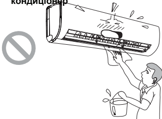
Це може привести до ушкодження або поразки електричним струмом
