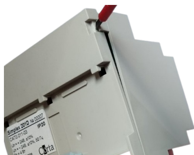
Рисунок 7 -Зняття нижньої кришки
