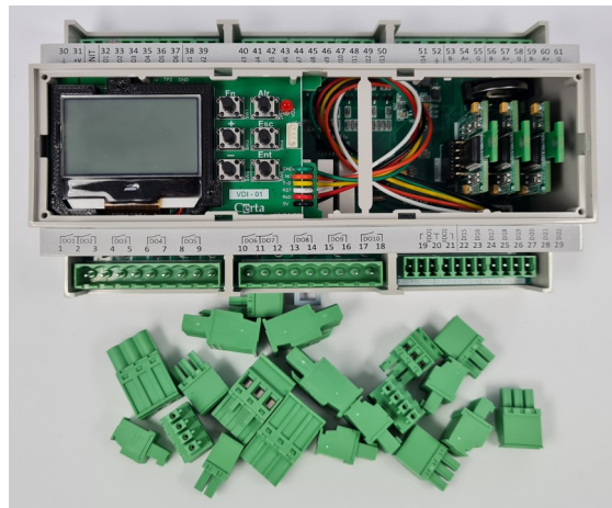
Рисунок 6 – Зняті клеми і лицьова панель
