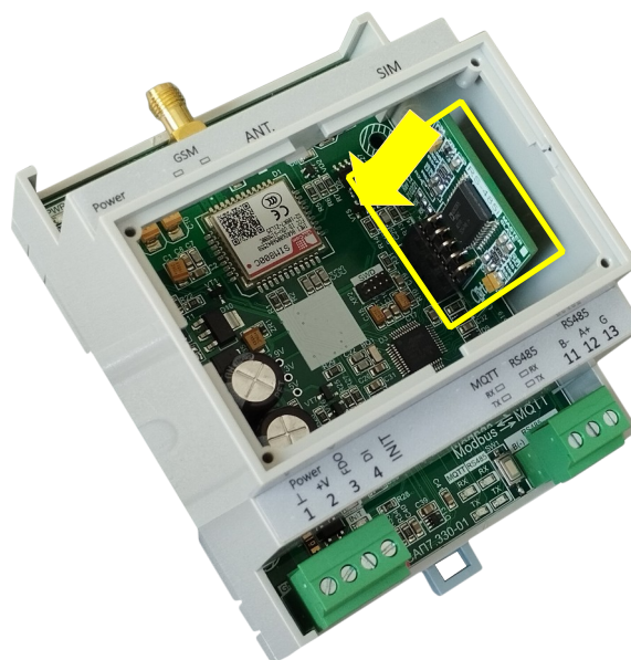
Рисунок 8 — Встановлення плати RS-485
