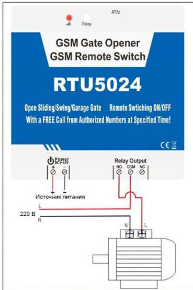
2. В качестве удаленного выключателя: включение или отключение насоса по телефонному звонку; насос запитывают от электросети, а RTU5024 — через отдельный блок питания.
