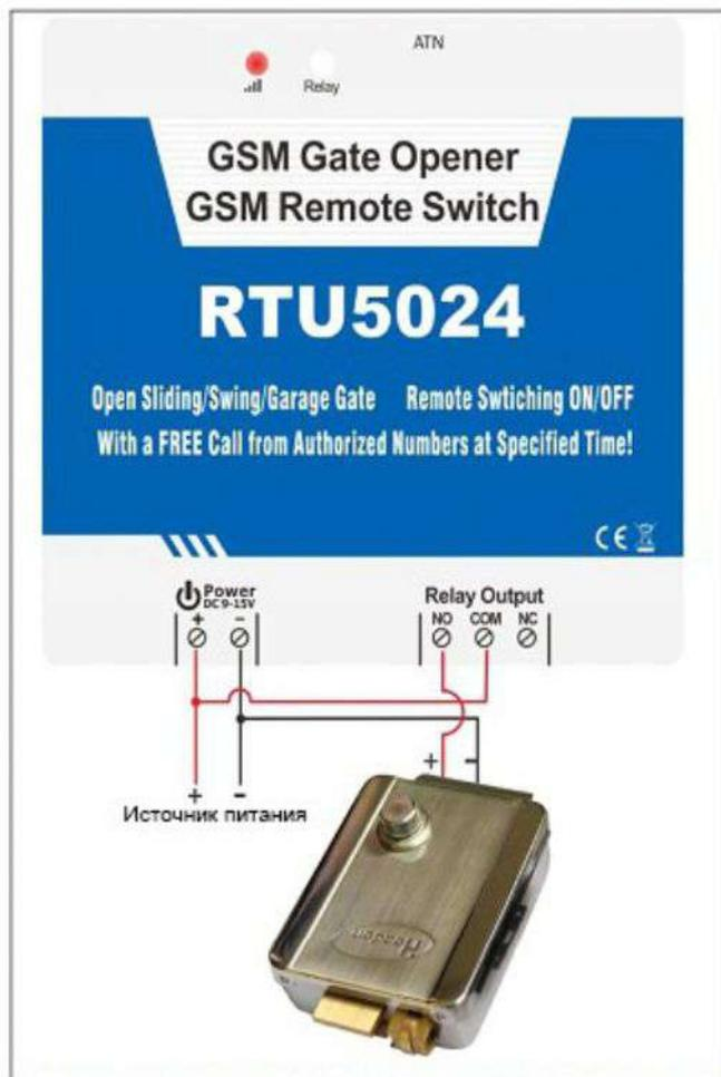
1. В качестве устройства автоматического открытия ворот: для питания RTU5024 и электронного замка необходимо использовать один и тот же источник; замок управляется по телефонному звонку.
