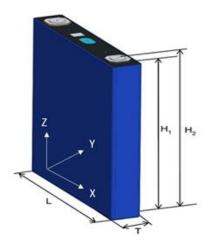
Fig.6 Diagram of LF150Cell direction 图 6 LF150 电池方向示意图
