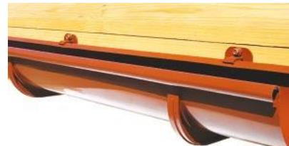
В кронштейнах металевих і ПВХ монтаж починаємо від вкладання заокругленого виступу ринви в передній виступ кронштейну, а далі втискаємо внутрішній край ринви під задній виступ.
