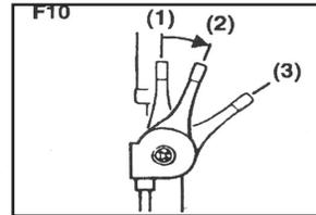
**ПРИМЕЧАНИЕ** При необходимости срочного перезапуска двигателя, поверните дроссельный рычаг в позицию открыто .
