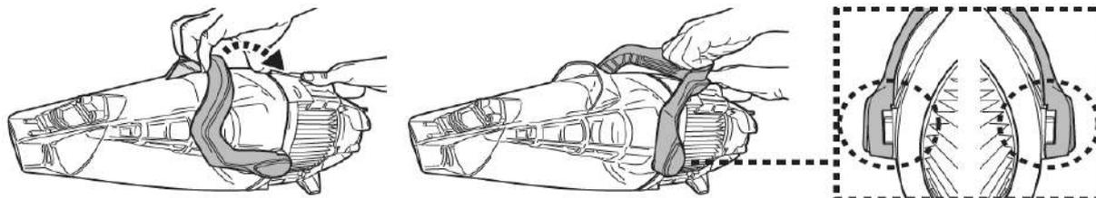
Отсоедините контейнер и поверните фильтровальную воронку против часовой стрелки до совмещения двух треугольных выступов. Выньте фильтровальную воронку из пылесоса.
