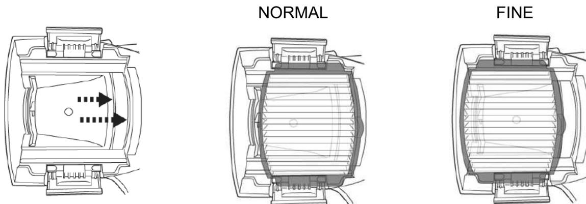
Для фиксации обеих защелок выполните действия в обратном порядке. Убедитесь, что крючок надежно закреплен за край патронного фильтра, а защелка полностью прижата к корпусу.
