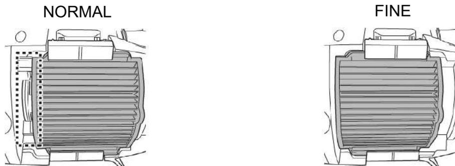
С двух сторон патронного фильтра находятся 2 одинаковые защелки. Подденьте зажим защелки, чтобы разблокировать фиксатор и освободить защелку. Повторите те же действия для противоположной стороны. Чтобы отсоединить патронный фильтр, возьмитесь за выступ на картридже.
