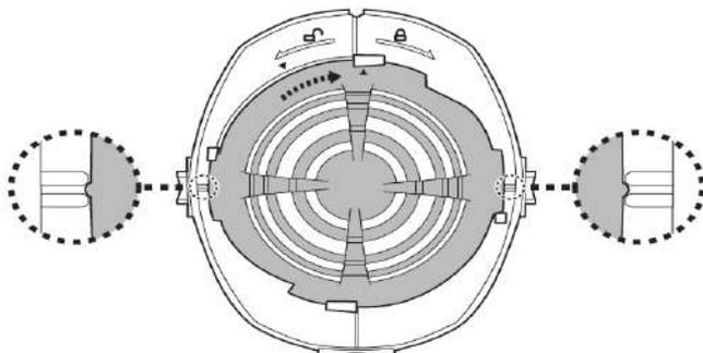
5. Выровняйте и снова установите крышку на пылесос и убедитесь, что рычаг зафиксирован, прижав его до упора к крышке. Вы услышите щелчок.
