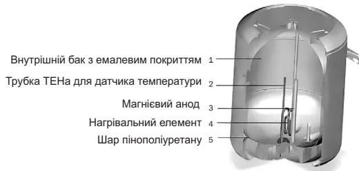
Рис. 1. ЕВАД Classic в розрізі та його складові частини
