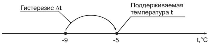
При этом охладительный элемент, управляемый терморегулятором, будет охлаждать морозильную камеру до  $-9^{\circ}\text{C}$  и отключаться. После повышения в ней температуры на  $4^{\circ}\text{C}$ , т.е. до  $-5^{\circ}\text{C}$ , терморегулятор снова включит охладительный элемент, начнется охлаждение и цикл повторится.
