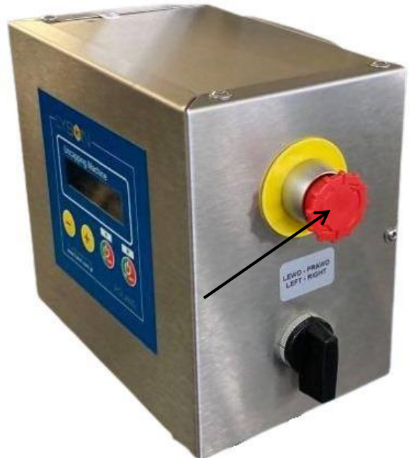
Фото 20. Аварійна кнопка СТОП
