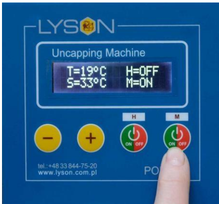
Фото 9. Вмикають ножі кнопкою №4 „ON/OFF”. Після увімкнення ножів на дисплеї з'явиться напис «ON» і ножі столу почнуть рухатись.
