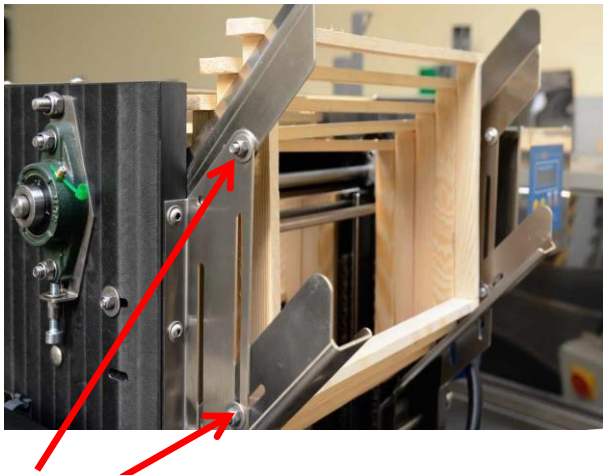
Фото 11. Регулювання верхньої та нижньої напрямних та правильне розташування рамок у них
