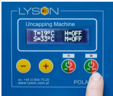
Фото 10. Вимкнення ножів кнопкою №4 „ON/OFF”. Після вимкнення ножів на дисплеї з'явиться напис „OFF” – ножі зупиняться
