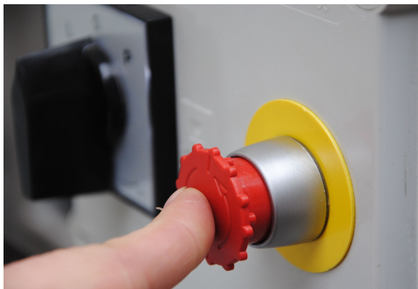
Фот. 15 Аварийная кнопка «СТОП»
