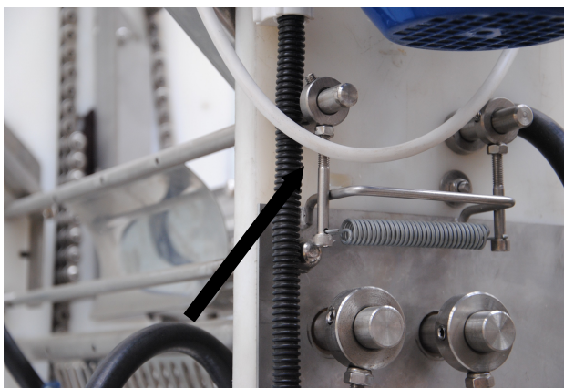
Фот. Винты для регуляции ножей распечатывателя
