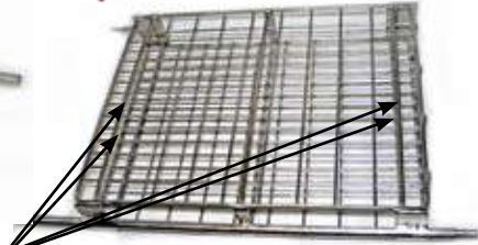
Укрепленные стенки кассеты при употреблении дополнительных брусьев
