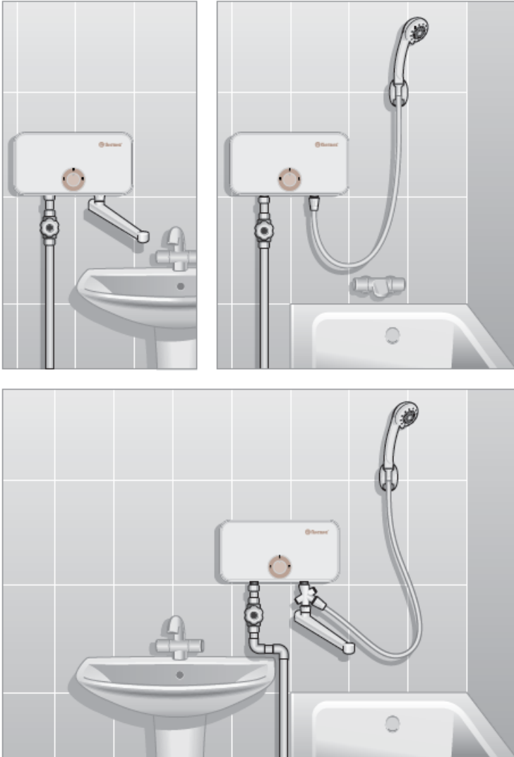
Малюнок 1. Можливі варіанти встановлення ПЕВН.
