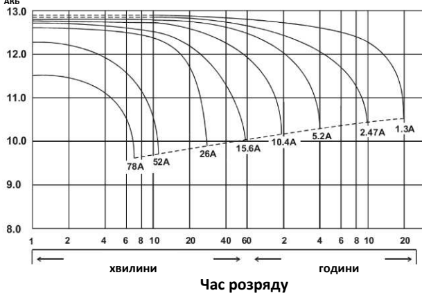
(В) для 12В АКБ Час розряду в залежності від струму розряду (25°C)
