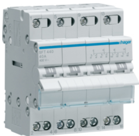
Перемикач I-0-II з загальним виходом зверху, 4-пол., 40A/400В
