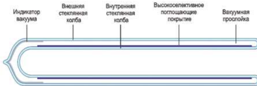
Продольный разрез коаксиальной вакуумной трубки
