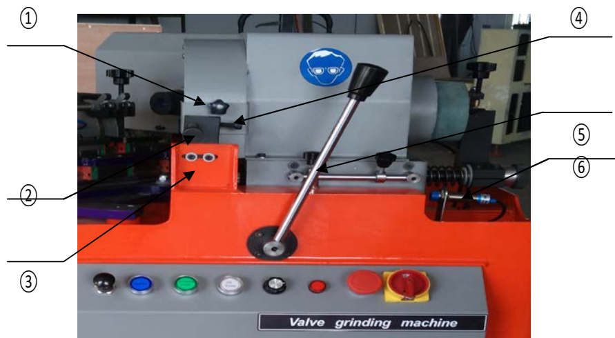
① окно для правки ② алмазный карандаш ③ узел правки ④ винтовой домкрат ⑤ рычаг подачи ⑥ индуктивный концевой выключатель
