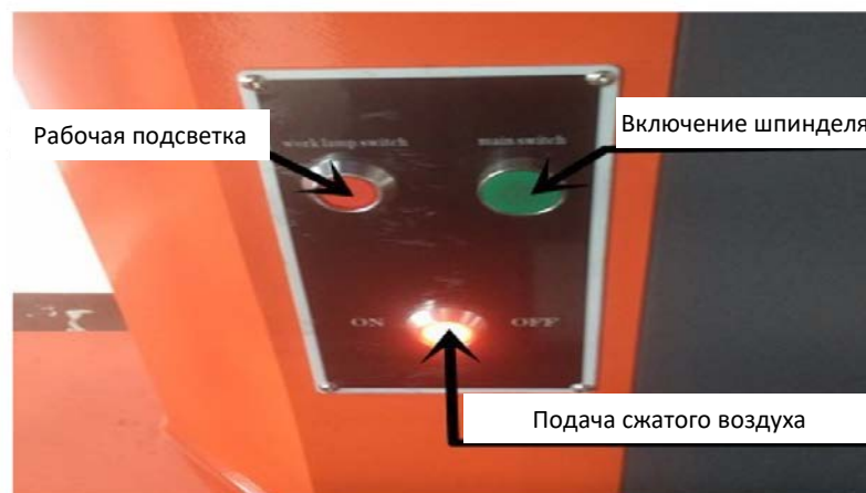
Рисунок 02 Панель управления на правой колонне
