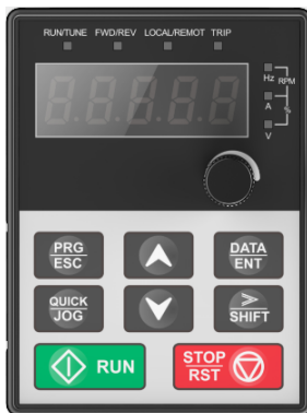
Рис.5.1 Зовнішній вигляд панелі керування (до 2,2 кВт)
