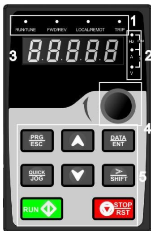
Рис. 5.2 Панель керування (4-400 кВт)
