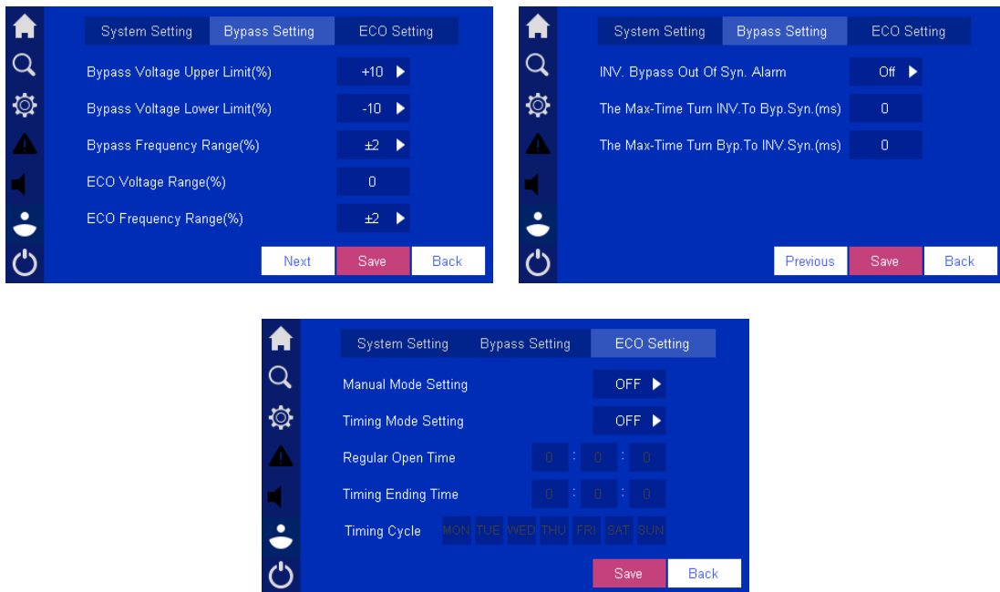
Rysunek 5-25 Parametry zasilania prostownika, bypassu oraz ustawienia ECO mode
