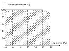
Figure B-1 Diagram of actual temperature derating
