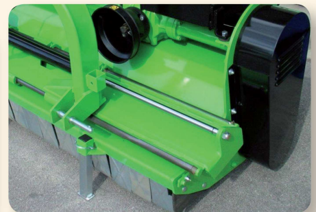
Spostamento idraulico di serie dell'attacco a 3 punti per Bull Super. Hydraulic side offset standard on 3 point linkage for Bull Super. Attelage 3 points avec déport hydraulique standard par Bull Super. Hydraulischer Seitenverstellung Standard der 3-Punkt Aufnahme für Bull Super.
