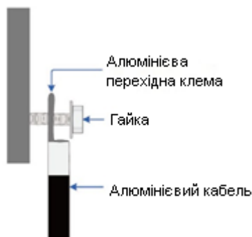
Малюнок 5.4 – Послідовність підключення алюмінієвого кабелю
