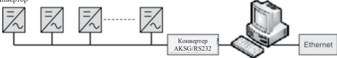
Рисунок 8 – ПК здійснює моніторинг через інтерфейс AKSG
