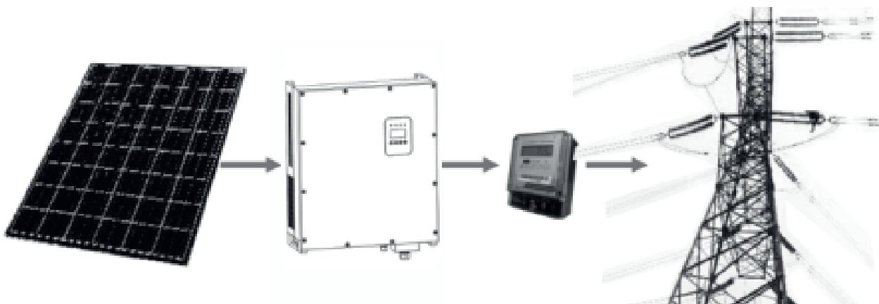
Рисунок 1 – Використання фотоелектричного інвертора, з'єднаного з електричною мережею в системі виробництва електроенергії.
