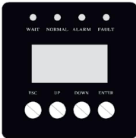
Рисунок 6 – Панель керування із РК-дисплеєм
