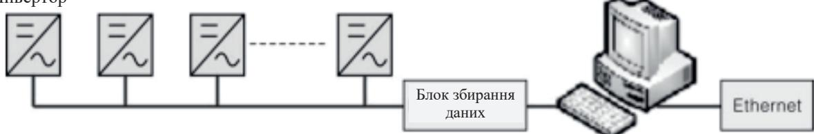
Рисунок 9 – Блок збирання даних і ПК здійснюють моніторинг через інтерфейс AKSG
