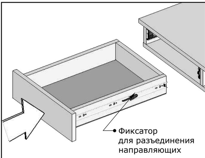
Устанавливаем ящики на направляющие до характерного щелчка.
