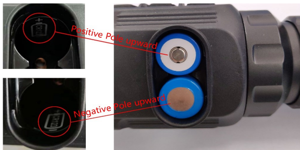
Мал.2 Встановлення ел. живлення
