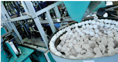
Последний цикл сборки крана - это установка ручки из термостойкого пластика.
