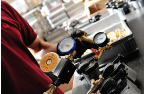
Сборка насосных групп для солнечных коллекторов.
