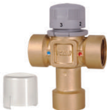
Термостатический смесительный клапан, присоединения-патрубки. Регулировка температуры 30-60°C. Максимальная температура воды на входе 85°C. Выход смешанной воды расположен снизу.
