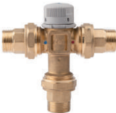
Термостатический смесительный клапан, присоединения-патрубки. Регулировка температуры 30-60°C. Максимальная температура воды на входе 85°C. Выход смешанной воды расположен снизу.
