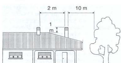
Размеры дымохода могут различаться в зависимости от его модели. Однако в целях обеспечения надлежащего выхода дыма, место прохождения воздуха в крышке дымохода должно быть в два раза больше, чем сама дымоходная труба, а крышка дымохода не должна мешать протоку воздуха.
