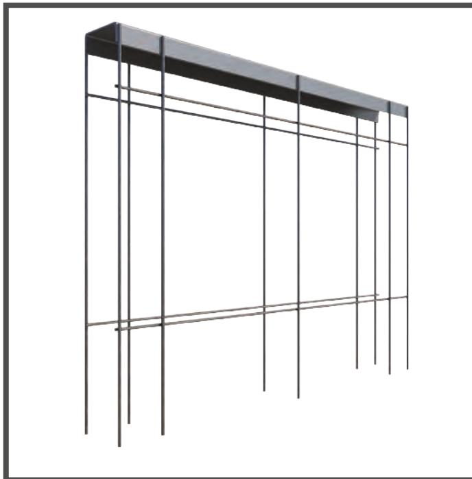
**Схема бетонирования швеллера.** Длина швеллера в половину проема, глубина бетонирования 1 метр.
