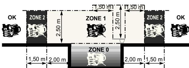
Установите насос в проветриваемом сухом месте. Для естественной вентиляции двигателя необходимо обеспечить свободную циркуляцию воздуха вокруг него. Необходимо периодически проверять, что охлаждению двигателя не препятствуют какие-либо объекты, листья и прочие предметы.
