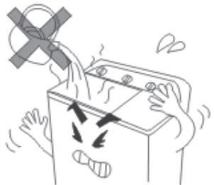
Чтобы избежать деформации деталей машины не заливайте в нее воду высокой температуры.
