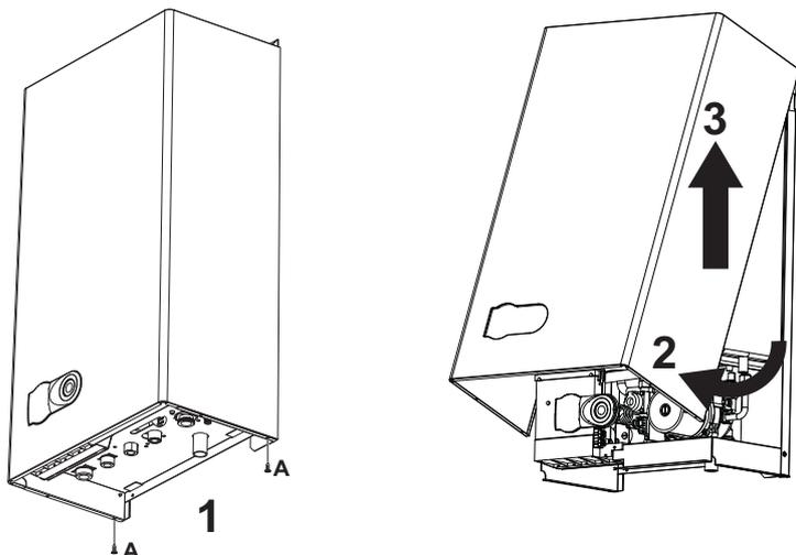
мал. 7 - Відкриття обшивки
